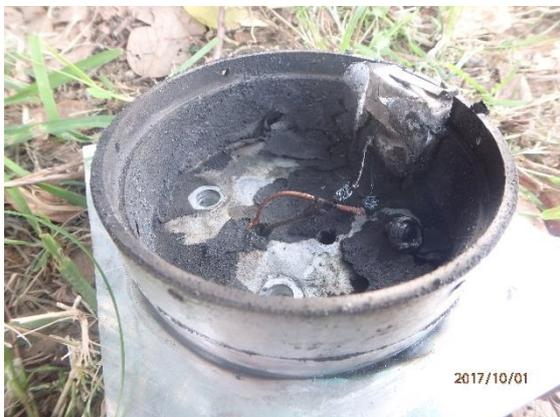
図 13 燃焼試験結果 2-1(離床しない)
