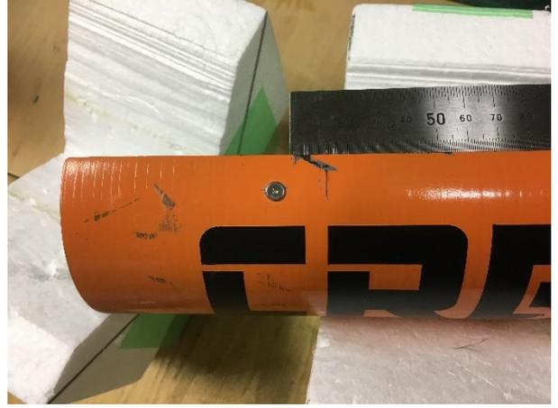
図7 フェアリングの損傷状況
