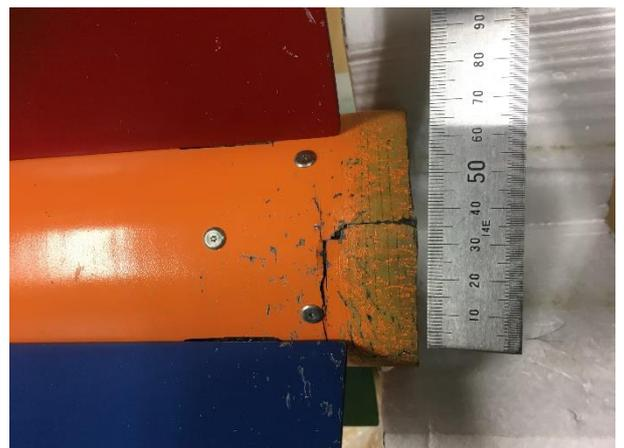
図9 1段目ボディーチューブの損傷状況
