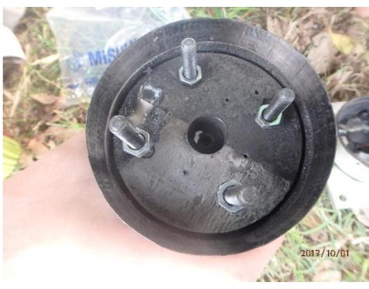
図 14 燃焼試験結果 2-2(離床しない)
