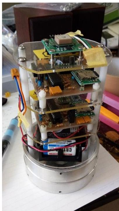
図 4 電装基板及び基板台
