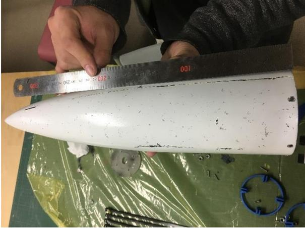
図6 ノーズの損傷状況
